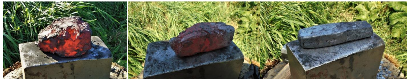
Spužvasto željezo nastalo taljenjem u rekonstrukciji peći na istek i rezultat naknadne konsolidacije - ingot (Lorenčić 2017, fig 8, a - d)
