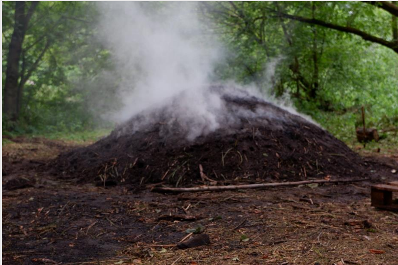
SLIKA 11. IZGARANJE UGLJENICE, VIDLJIVE FAZE IZGARANJA I SMANJENJE VOLUMENA TE SLIJEKANJE UGLJENICE
