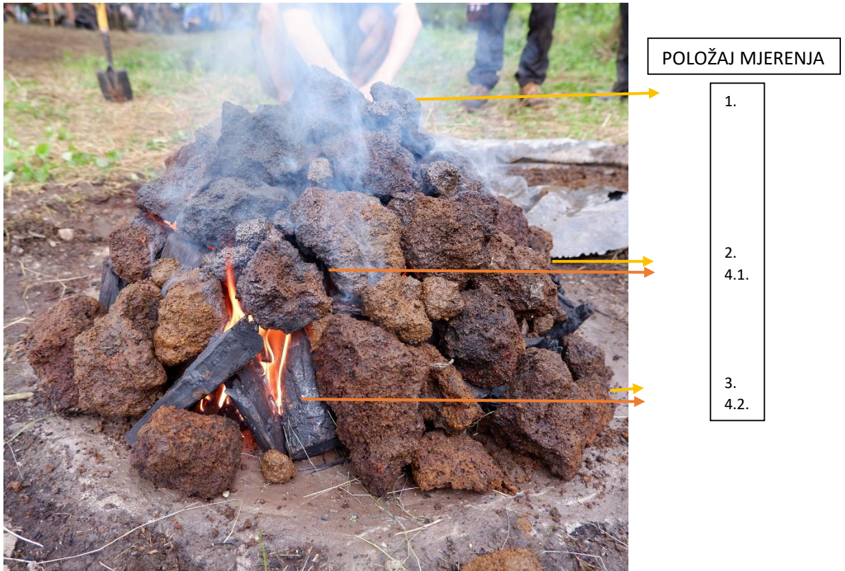
SLIKA 5. POLOŽAJI MJERENJA TEMPERATURE
