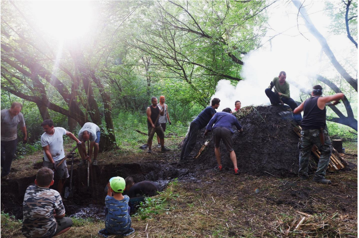
SLIKA 10. IZGRADNJA I PALJENJE PEĆI
