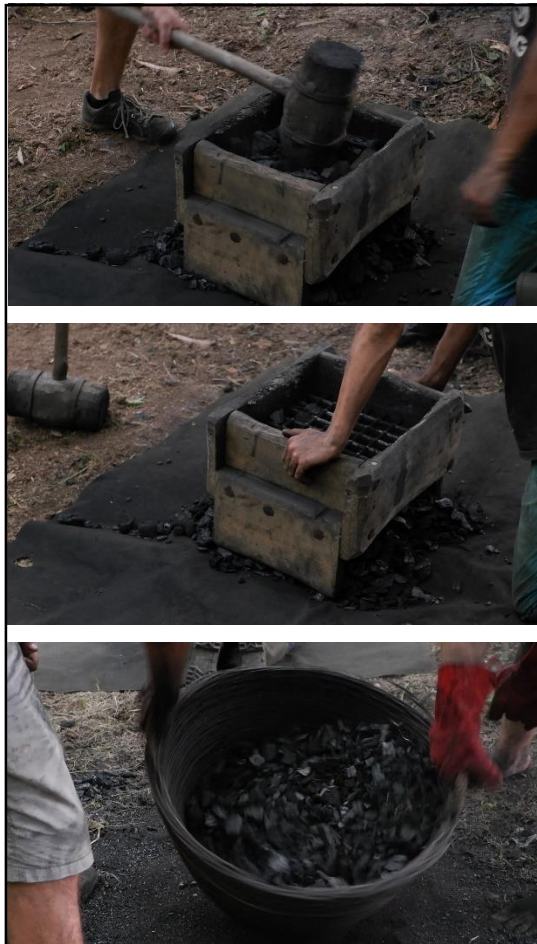
SLIKA 12. POSTUPAK PRIPREME UGLJENA; USITNJAVANJE I PROSIJAVANJE
