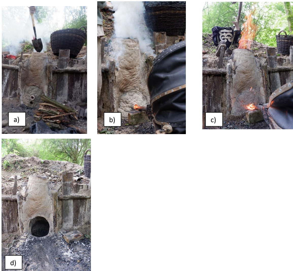
SLIKA 13. PEĆ 1. U RAZLIČITIM FAZAMA TIJEKOM I NAKON TALJENJA A) SUŠENJE; B) ZAGRIJAVANJE; C) TALJENJE; D) NAKON 1. TALJENJA
