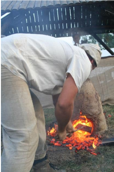
Slika 21. Izvlačenje užarenog ugljena iz Peći 1
