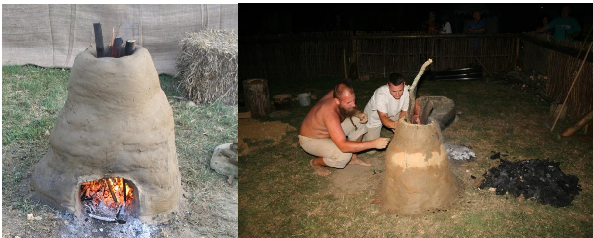
Slike 9, 10. Sušenje Peći 1 i zamazivanje pukotina na vanjskoj stjenki
