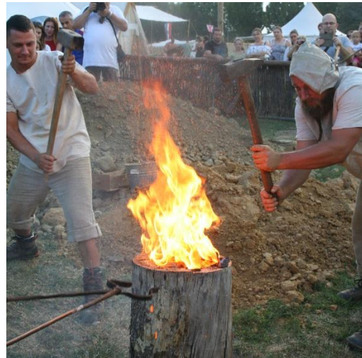
Slike 23, 24. Oblikovanje dobivenog komada spužvastog željeza
