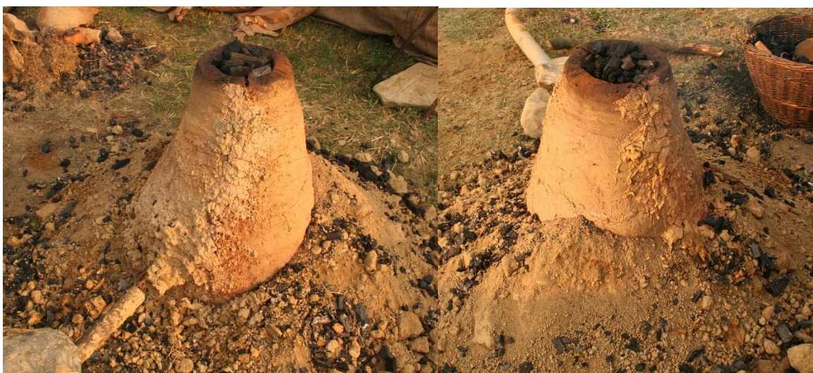
Slike 41, 42. Peć 3 tijekom taljenja. Vidljivi popravci stjenke žitkom glinom
