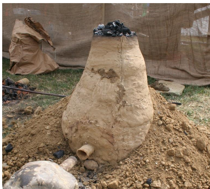
Slika 40. Oblaganje Peći 3 zemljom i zagrijavanje
