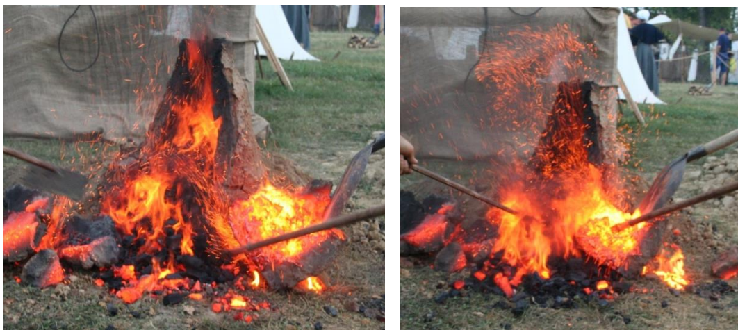
Slike 48, 49. Odvajanje komada spužvastog željeza od „vrata“ peći
