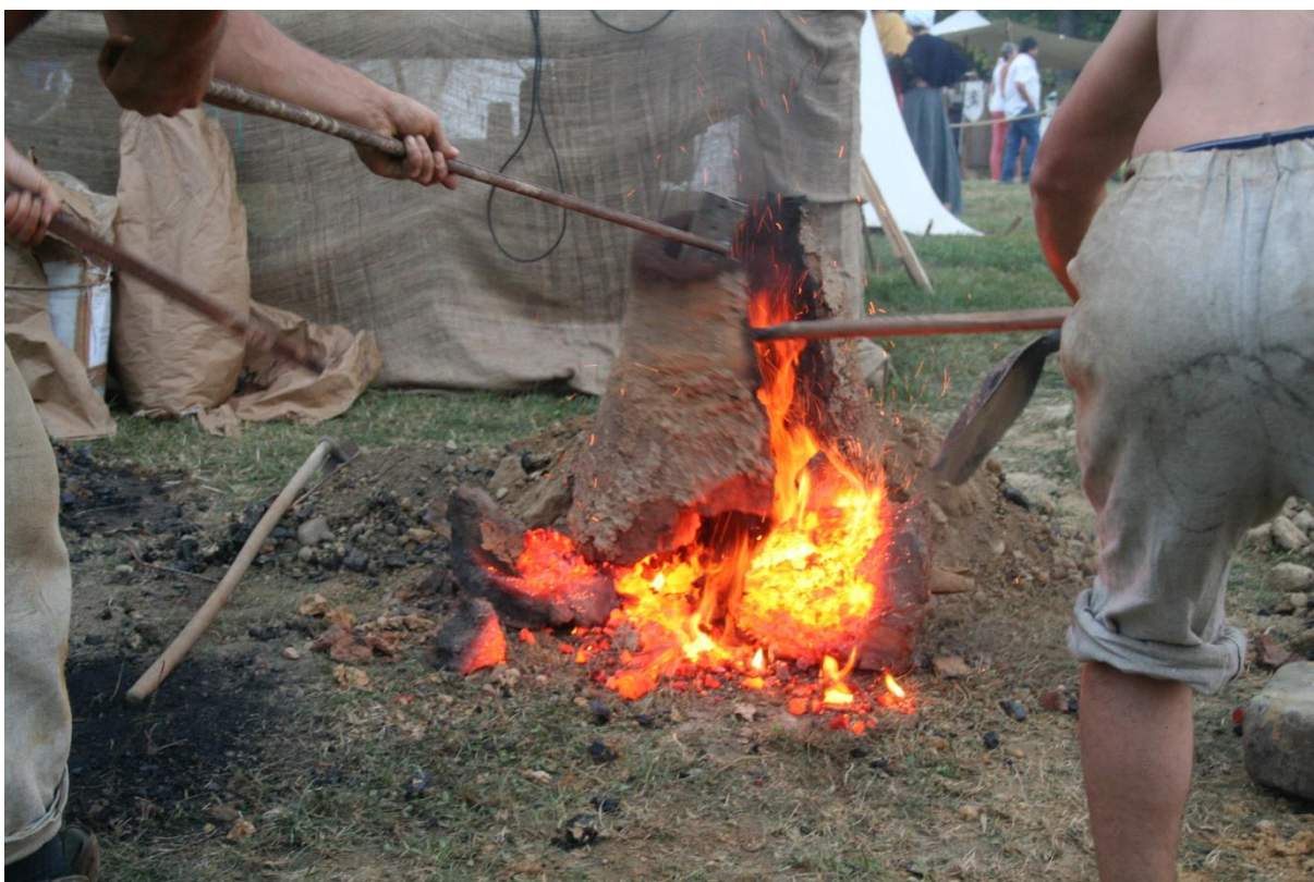
Slika 47. Rušenje konstrukcije Peći 3 da se izvuče bloom
