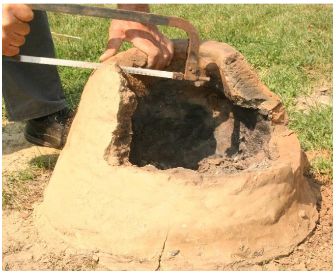
Slike 55, 56. Izrada presjeka Peći 2. U unutrašnjosti vidljivi komadi rude koja se nije rastalila
