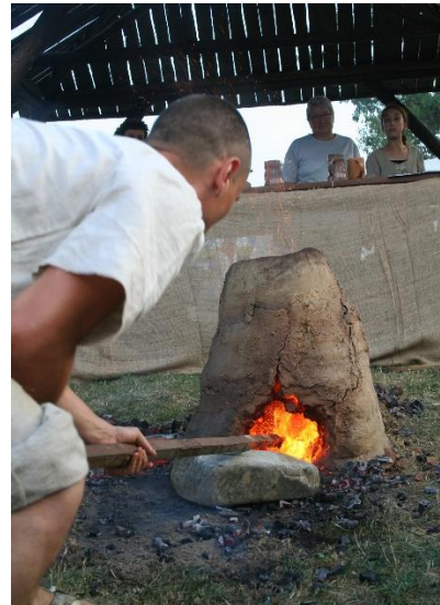
Slika 22. Izvlačenje bloom-a iz peći
