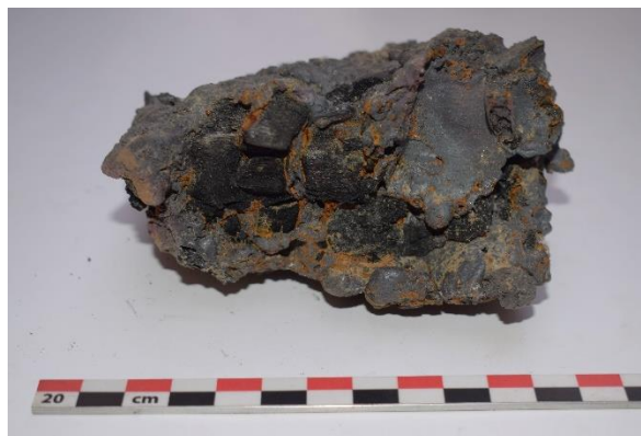
Slike 73, 74. Nereducirani komadići ugljena unutar komada zgure iz Peći 1
