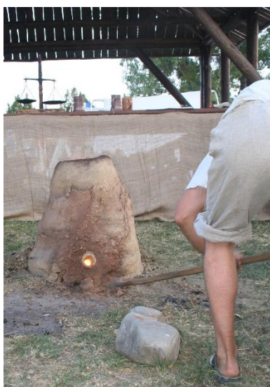
Slika 17. „Tapanje“ otvora na dnu Peći 1
