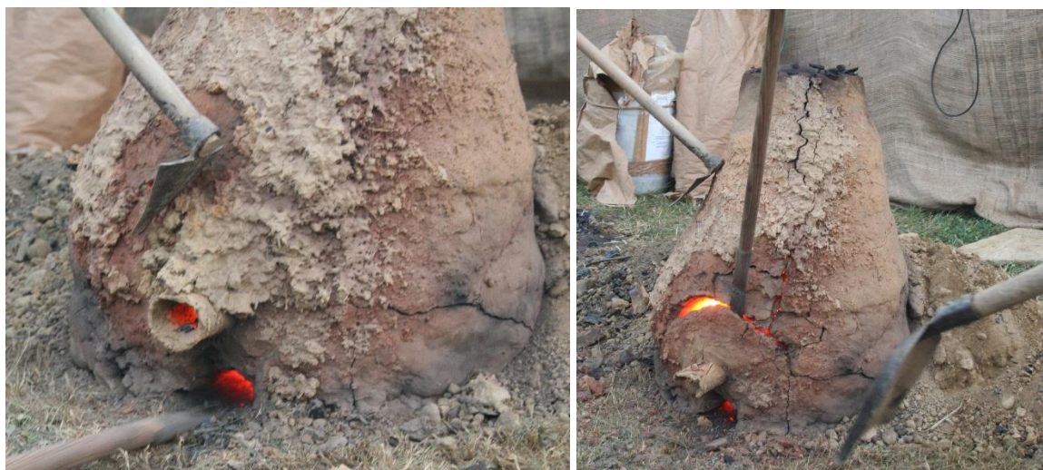
Slike 44, 45. Otvaranje otvora na dnu Peći 3 i početak otvaranja vrata peći
