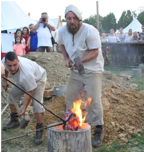
Slike 23, 24. Oblikovanje dobivenog komada spužvastog željeza
