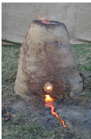
Slika 18. Izlazak zgure iz Peći 1
