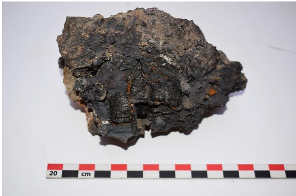
Slike 73, 74. Nereducirani komadići ugljena unutar komada zgure iz Peći 1
