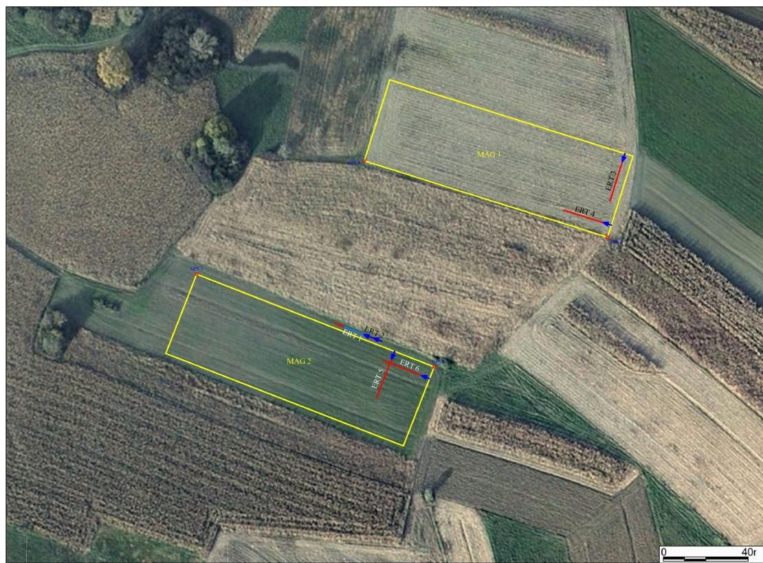
Slika 7. Novigrad Podravski – Milakov Berek. Površine istražene magnetskom metodom i profili za 2D geoelektričnu tomografiju.
