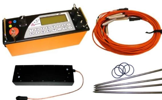
Slika 18. Mjerenje profila za 2D geoelektričnu tomografiju.
