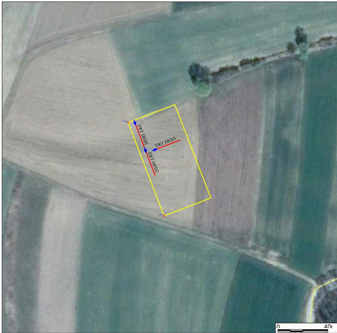
Slika 11. Hlebine-Dedanovice. Površine istražene magnetskom metodom i profili za 2D geoelektričnu tomografiju.
