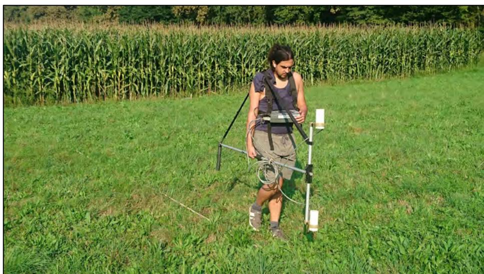
Slika 2. Mjerena magnetskom metodom primjenom magnetometra Geometrics G-858 na gradientan način na lokalitetu Bakovčice – Velike livade (foto: B. Mušić).
