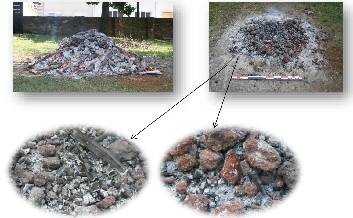
Slika 5. Tijek postupka prženja rude – nakon 2 sata gorenja i pred kraj prženja. Vidljivi ostaci pougljenog drva i pepela te promjena boje rude
