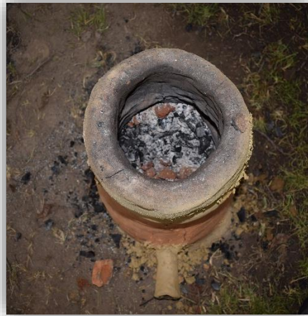
Slika 13. Pogled u unutrašnjost peći 2 nakon taljenja (dan kasnije). Vidljiva u potpunosti nereducirana ruda, na visini od 45 cm od dna peći.
