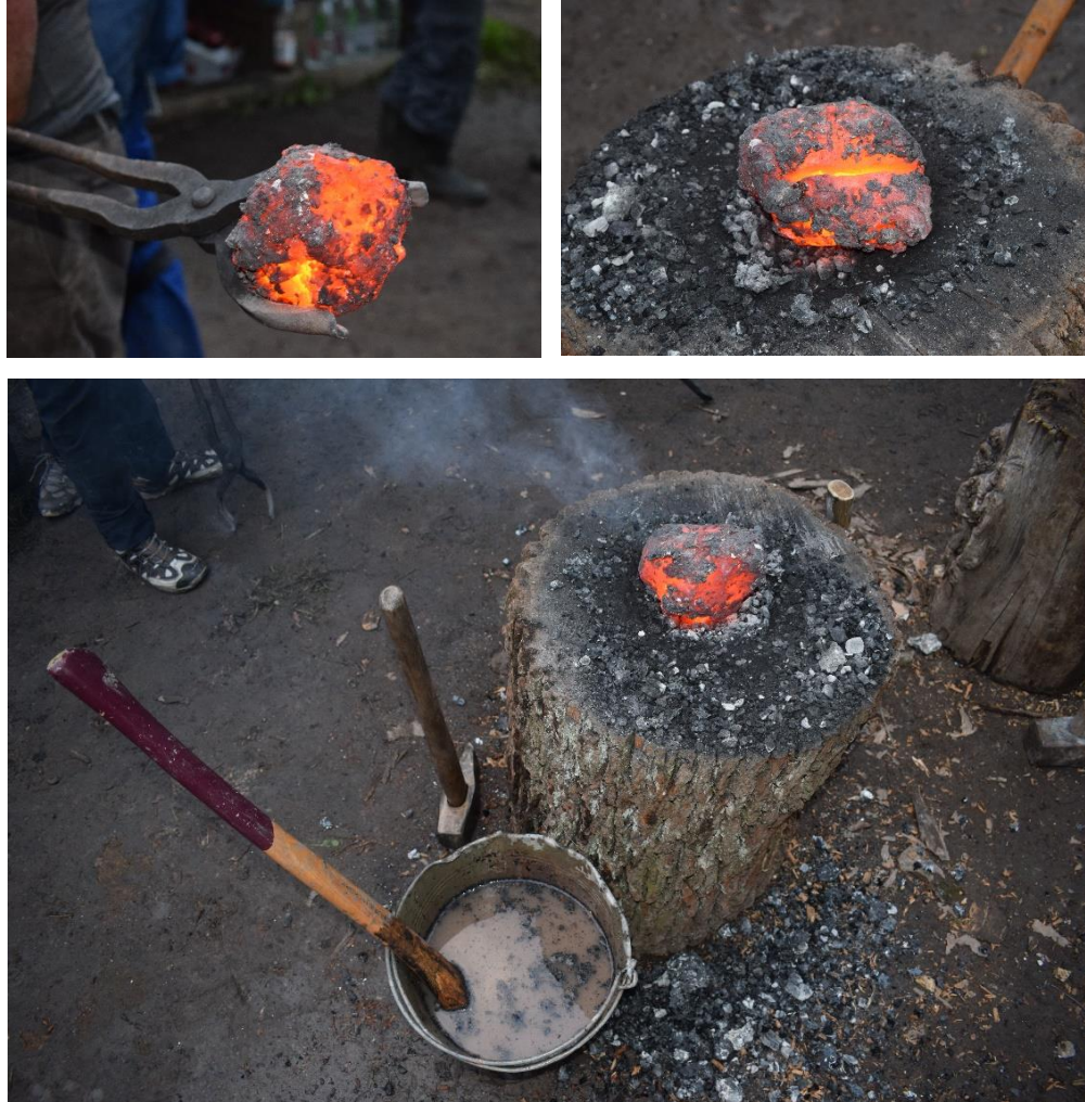
Slika 13. Spužvasto željezo iz peći 2. nakon oblikovanja i testiranja kvalitete (rascjep po sredini spužvastog željeza).
