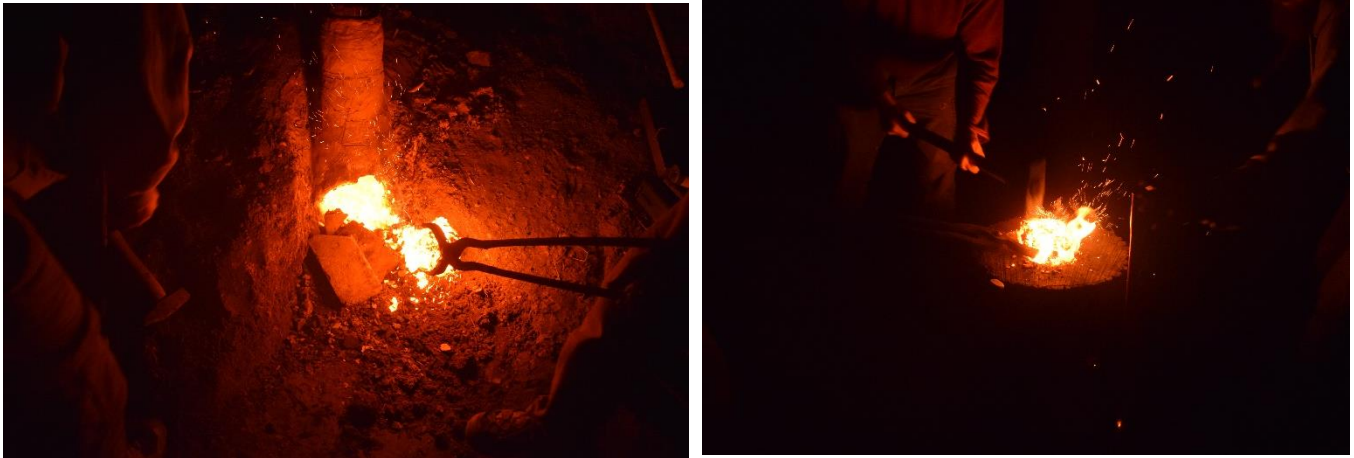
Slika 23. Izvlačenje spužvastog željeza iz peći, oblikovanje i kompaktiranje
