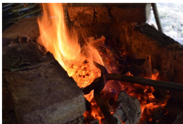
Slika 33. a) Smještaj spužvastog željeza u ognjištu (boja ukazuje da je postignuta dovoljna temperatura) b) vađenje spužvastog željeza
