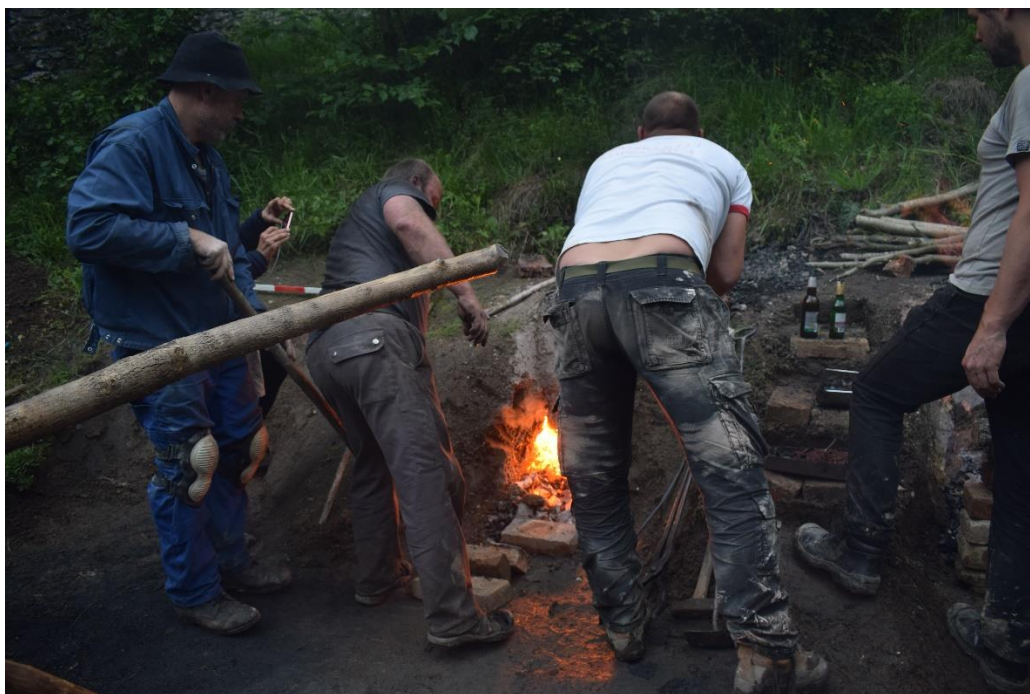
Slika 12. Peć 2.: Otvaranje vrata peći i izbacivanje nakupljene zgure i pepela
