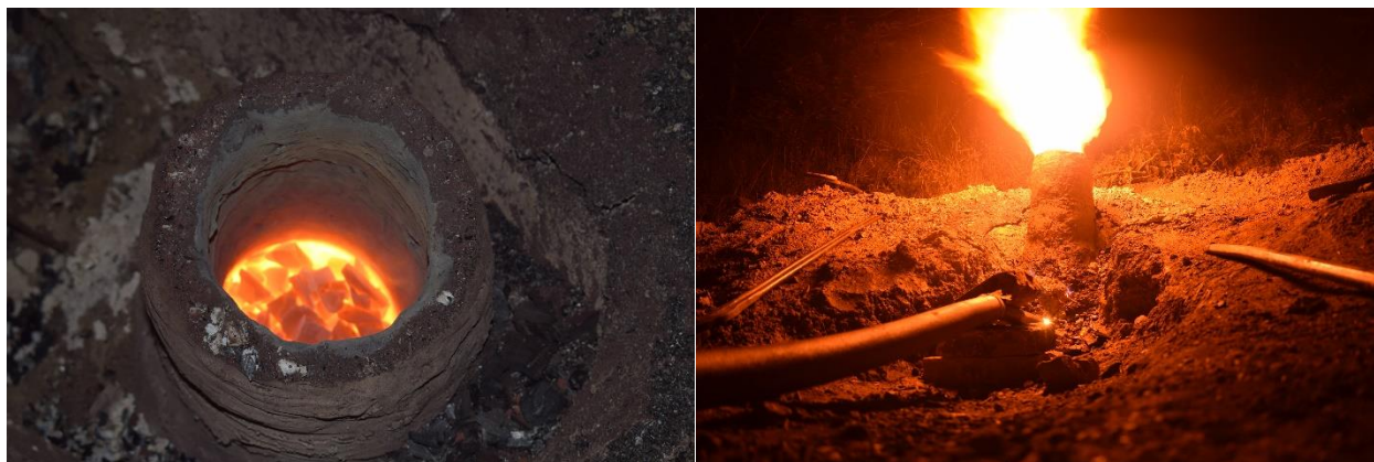
Slika 27. Zadnja faza taljenja, sagorjevanje ugljena do razine ispod koje se formira spužvasto željezo
