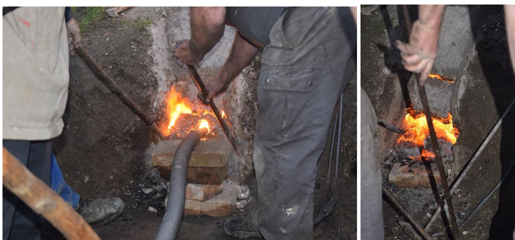
Slika 11. Peć 2.: Izgaranje zadnjih mjerica ugljena, razmještanje ugljena neposredno pred otvaranje vrata peći
