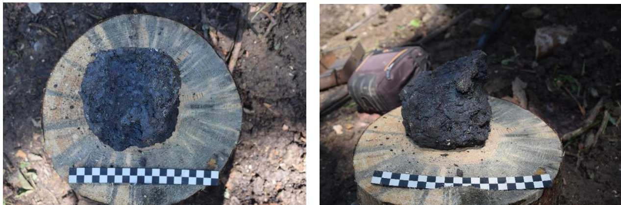
Slika 24. Ohlađeno spužvasto željezo (peć 4. 1 taljenje)
