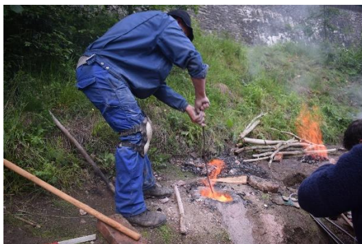
Slika 11. Peć 2.: Izgaranje zadnjih mjerica ugljena, razmještanje ugljena neposredno pred otvaranje vrata peći
