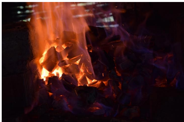
Slika 33. a) Smještaj spužvastog željeza u ognjištu (boja ukazuje da je postignuta dovoljna temperatura) b) vađenje spužvastog željeza
