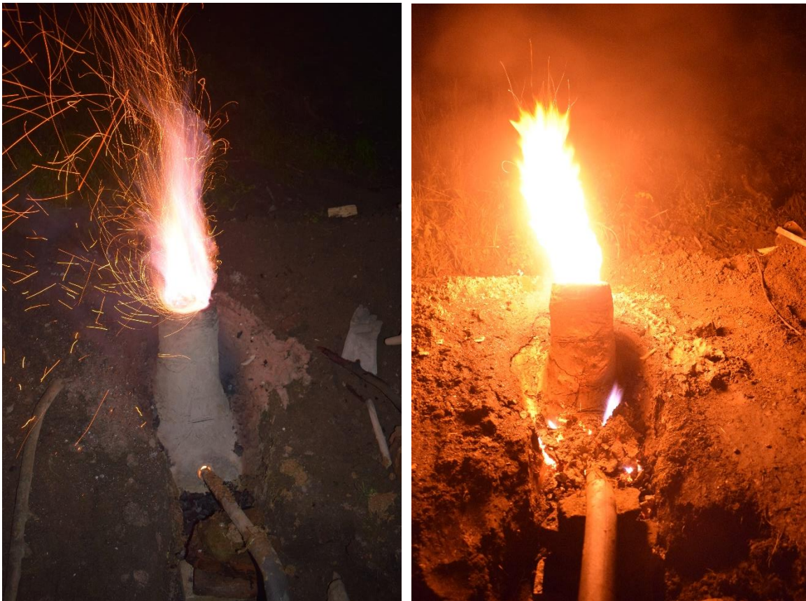
Slika 22. Peć 4 a) početak taljenja b) završna faza taljenja (uslijed pucanja stijenke, pukotine su zatvorene žitkom mješavinom gline te dodatno zatrpane zemljom)
