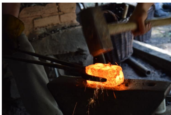
Slika 34. Kovanje spužvastog željeza
