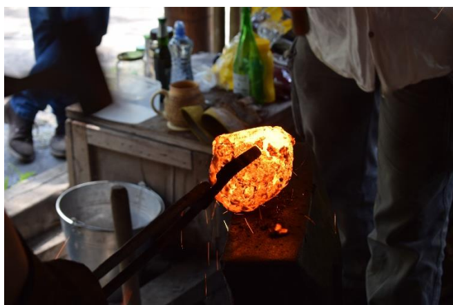
Slika 34. Kovanje spužvastog željeza
