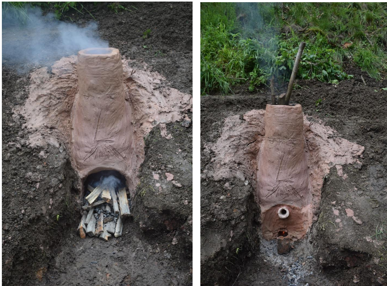
Slika 20. Sušenje peći 4. a) prva faza sušenja ložišta i prostora oko vrata b) druga faza sušenja s umetnutim vratima
