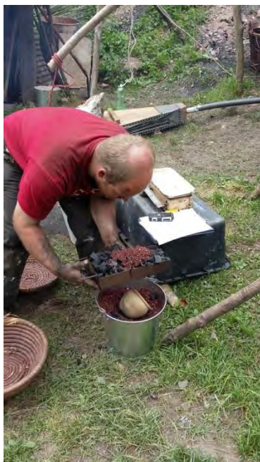
Slika 23 – mjerenje količine rude getita
