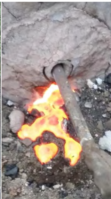
Slika 57 – peć 6_1, ispuštanje tekuće zgure
