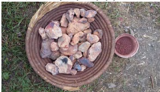
Slika 18 – getit/limonit: veća granulacija – nepržena ruda, manja granulacija – pržena ruda
