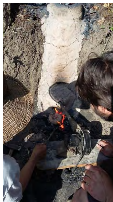
Slika 55 – peć 6_1, upuhivanje zraka uz pomoć ventilatora
