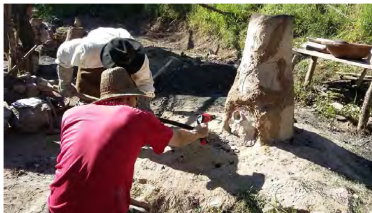
Slika 73 – peć 5_3, mjerenje temperature taljenja
