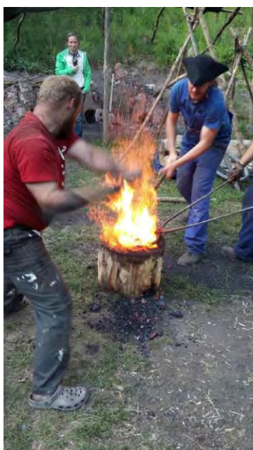
Slika 26 – oblikovanje blooma iz peći 4
