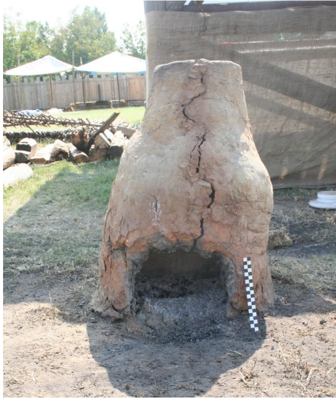
Slika 13. Konstrukcija peći 1 nakon drugog taljenja
