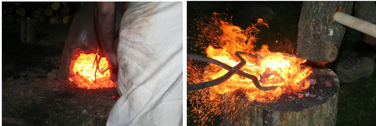
Slika 11. Vađenje spužvastog željeza iz peći i kompaktiranje, Peć 1. 2 taljenje
