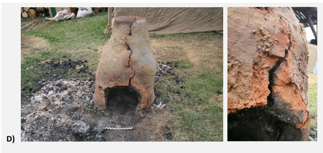
Slika 10. Peć tijekom postupka taljenja A) Sušenje – 1. faza: prije umetanja vrata, neposredno po izgradnji 2. faza: nakon umetanja vrata sa sapnicom B) Zagrijavanje C) Taljenje, ispuštena tekuća zgura D) Nakon postupka
