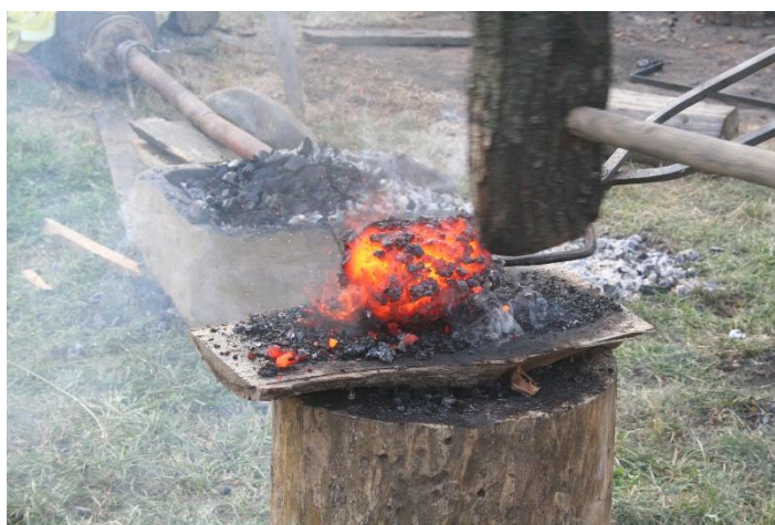
Slika 19. Peć 3. tijekom postupka taljenja A) Sušenje, neposredno po izgradnji B) Zagrijavanje C) Taljenje D) Rušenje peći i izvlačenje spužvastog željeza E) Kompaktiranje spužvastog željeza
