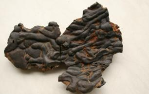
Zgura s dna ognjišta peći –
