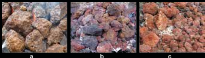
Sl. 11. Rezultati eksperimentalnog prženja močvarne željezne rude: a) prije prženja, b) nakon dva sata prženja (stožasta konstrukcija ložišta) i c) nakon šest sati prženja (rešetkasta konstrukcija ložišta) (prema: Karavidović 2020: sl. 3)
