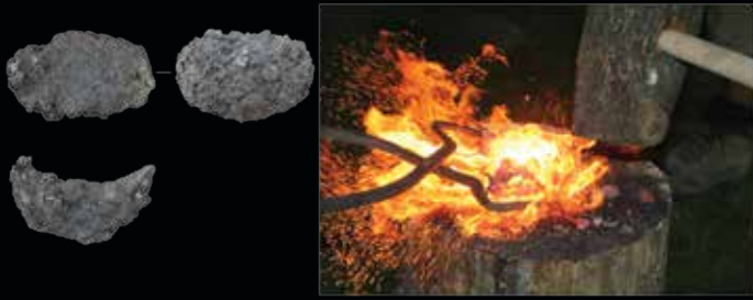
Sl. 14. Postupak kompaktiranja (desno) i dobiveno spužvasto željezo (lijevo). Renesansni festival, Koprivnica 2019. (snimila: T. Karavidović)
